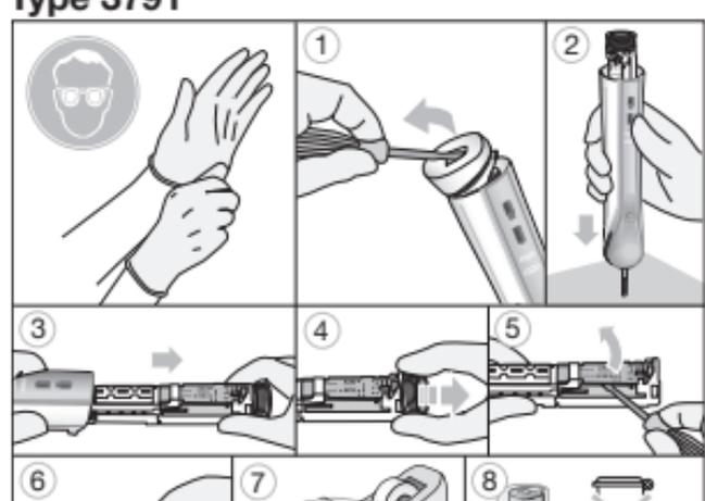
Ouvrir le compartiment à pile situé dans le manche comme indiqué, retirer la pile et la jeter conformément aux règlements locaux. Attention! L'ouverture du manche rend l'appareil inutilisable et invalide la garantie.
